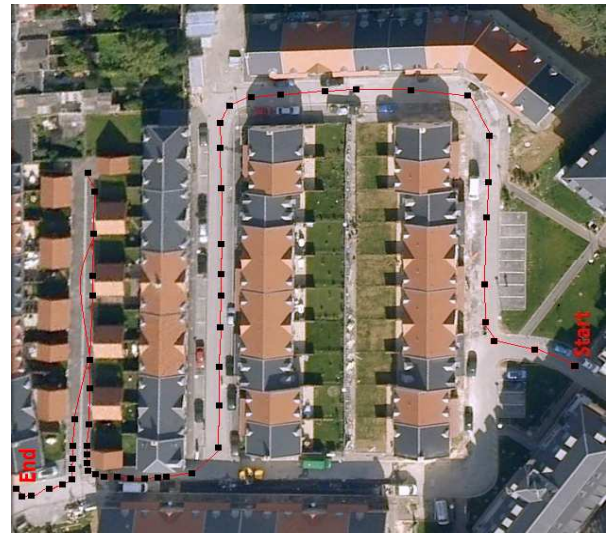
FIGURE 5 – Carte topologique construite par le robot, superposée à la vue Google Earth. En rouge, la position géographique des signatures ayant amenées à la création d'un nouveau noeud. En noir, les liens existant entre les noeuds.
