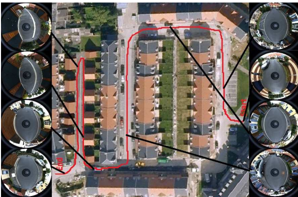
FIGURE 4 – Vue Google Earth de l'environnement de test, avec un ensemble de vues présentées à gauche et à droite. En rouge, La trajectoire que le robot a suivie sans aucune intervention humaine.
