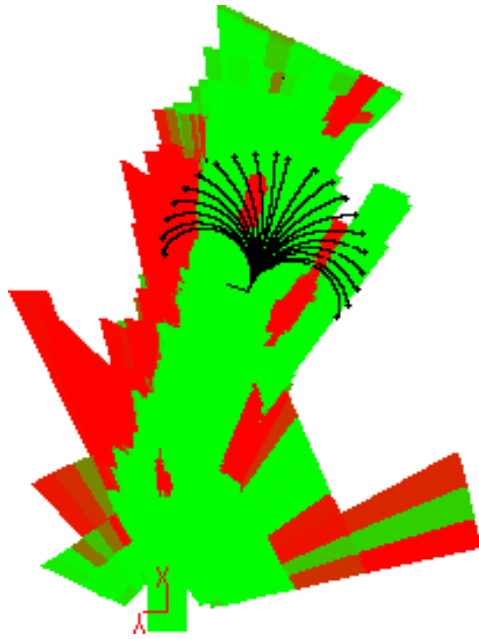
FIG. 1.22 – Un ensemble d’arcs de cercles évalués sur le modèle qualitatif du terrain construit (à gauche), et sa reproduction dans la vue courante qu’à le robot du terrain, dans laquelle l’arc choisi est en blanc (à droite)
