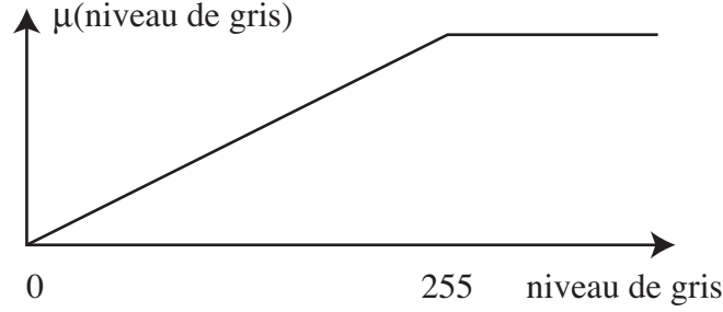
Figure 16 : association d'une fonction d'appartenance aux niveaux de gris;
