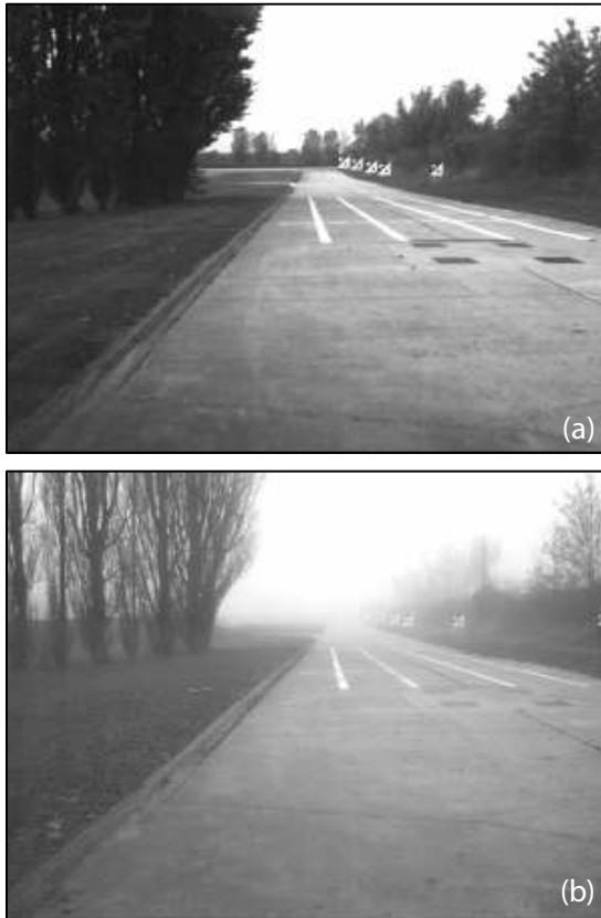
FIG. 7 – Site dédié au calibrage des algorithmes de mesure de visibilité atmosphérique comportant les cinq cibles spécifiques. (a) Image du site par beau temps ; (b) Image du site par temps de brouillard léger ( V_{met} \approx 200 m).
