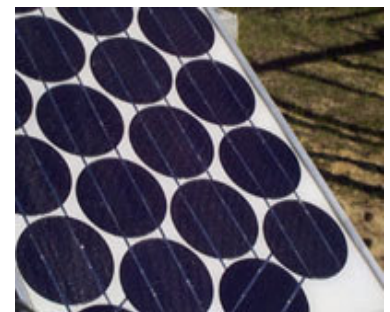
Figure 4-7 : Panneau PV constitué par M cellules séries et N colonnes de cellules parallèles A) structure d'un panneau PV, B) panneau solaire en silicium monocristallin [144].
